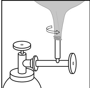
Die Ballonöffnung sehr dicht über den Füllkopf stülpen.
