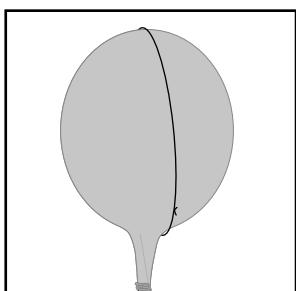
Die beigelegte Masschnur an der Naht entlang über den Ballon legen. Sobald der Ballon die Schnur ausfüllt, das Gas abstellen.
