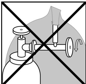
Achten Sie darauf, dass der Ballon beim Öffnen des Gasventils nach oben gerichtet ist. Hängt der Ballon nach unten, kann die Gummihaut vom ausströmenden Gas zerstört werden.
